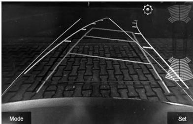
Ist eine optionale Rückfahrkamera installiert worden, wird sobald der Rückwärtsgang eingelegt wurde, automatisch das Bild der Kamera auf dem Bildschirm gezeigt (Siehe S. 35). Dies geschieht auch dann, wenn das Gerät ausgeschaltet ist. Nach dem der Rückwärtsgang wieder ausgelegt wurde, startet das Gerät wieder die zuvor benutzte Anwendung oder Funktion.
