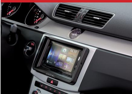
Die Padbay-Blende ist gleichzeitig Halterung für das iPad mini sowie Radiohalterung für ein Nachrüstgerät\*.
