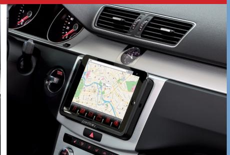
Das iPad mini wird via Bluetooth mit dem Autoradio gekoppelt und ersetzt dessen Multimedia-Oberfläche. Mit der speziell für den Einsatz im Auto konzipierten **Padbay App** kann auf viele Funktionen wie Media Player, Nachrichten versenden, Navigation etc. schnell und einfach zugegriffen werden.
