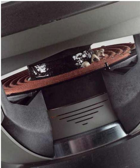
Die Litzen, die über 10-mm<sup>2</sup>-Millimeter Kabelstränge nach außen geführt sind, liegen zwischen den Zentrierungen
