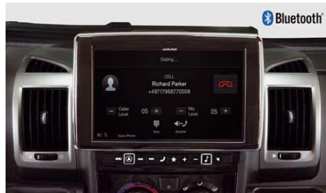
Das integrierte Bluetoothmodul ermöglicht drahtloses Freisprechen und Audiostreaming
